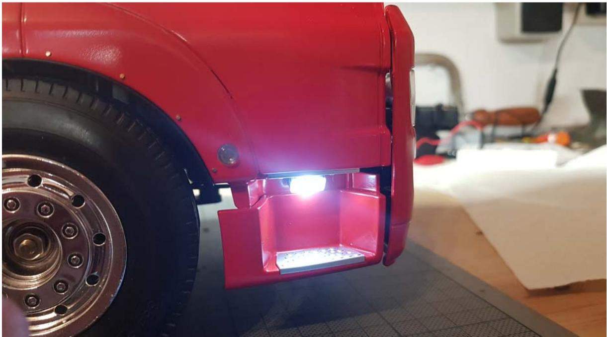
Um in die Auflieger und den Wechselaufbau nicht noch zusätzliche Akku's verbauen zu müssen, fertigte ich mir eine Steckerbrücke für die Versorgungsspannung und Steuersignale einiger Funktionen wie Rückfahrlicht, Bremslicht und Warnblinker.
